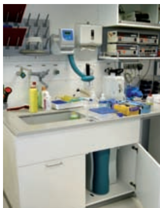
Reinstwasseraufbereitungssystem TKA GenPure unten im Laborschrank, Bedienung und Reinstwasserentnahme über den oberhalb der Arbeitsfläche an der Wand angebrachten TKA Dispenser X-CAD.
