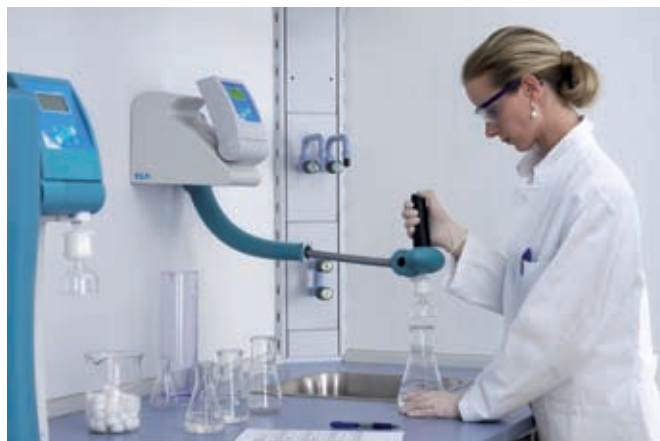
Die ausziehbare Entnahmepistole lässt sich immer in die günstigste Position zum Befüllen unterschiedlichster Flaschen und Behälter bringen.
